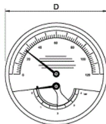
Диапазон отображения давления 0-4 бар, диапазон отображения температуры 0-120 °С, с зеленым указателем для маркировки рабочего давления.
