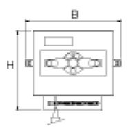
Интерфейс RS 485 для связи с блоком управления BrainCube, 6 цифровых входов для регистрации и индикации внешних безпотенциальных сигналов, 9 цифровых безпотенциальных выходов с возможностью индивидуальной параметризации, все выходы могут иметь обратный сигнал. Настенное крепление, фиксирующие элементы для оптимальной прокладки кабеля.
