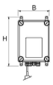
2 гальванически разделенных аналоговых выхода 4-20 мА для подключения к системе управления зданием, отдельный источник питания напряжением 2,5 кВ переменного тока. Полный электрический монтаж в пластмассовом корпусе, настенное крепление.
