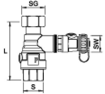
Внутренняя резьба, резьбовое соединение (с плоским уплотнением) для прямого подключения к подходящим расширительным бакам.
