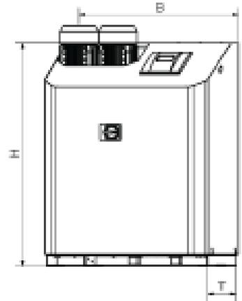
Точное поддержание давления  $\pm 0.2$  бар. 2 насоса. 1 перепускной клапан для дегазации и поддержания давления. 1 перепускной клапан для поддержания давления при пиковой нагрузке.
