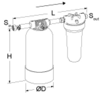
Гидравлический модуль для обессоливания воды, для использования с Vento/Transfero Connect TecBox. Фильтр с размером ячейки сетки 25 мкм для защиты системы. Колба для обессоливания, заполненная высококачественной смолой.
