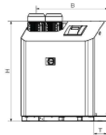
Точное поддержание давления  $\pm 0.2$  бар. 2 насоса. 1 перепускной клапан для дегазации и поддержания давления. 1 перепускной клапан для поддержания давления при пиковой нагрузке.
