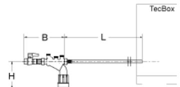
Гидравлический блок для работы подпитки с Vento/Transfero Connect. Состоит из запорного клапана, обратного клапана, фильтра и прерывателя обратного потока тип BA (класс защиты 4) в соответствии с EN 1717. Возможно подключение Pleno Refill.
