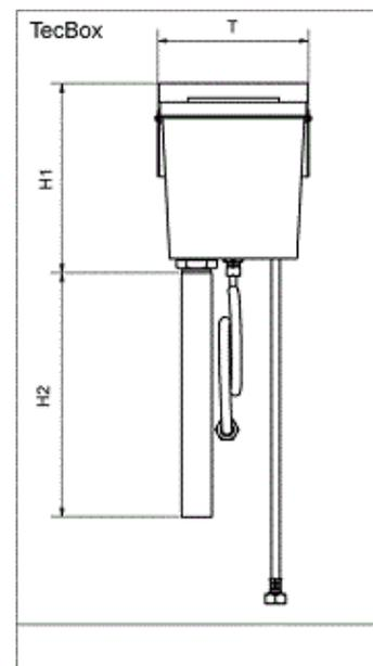
Гидравлический блок для работы подпитки с Vento/Transfero Connect. Состоит из промежуточного бака тип АВ (класс защиты 5) согласно EN 1717. Для монтажа с тыльной стороны установок. Может быть использован для подключения модулей умягчения сторонних производителей, имеющих производительность менее 1300 л/ч и, поэтому, не рекомендуемых к подключению напрямую.
