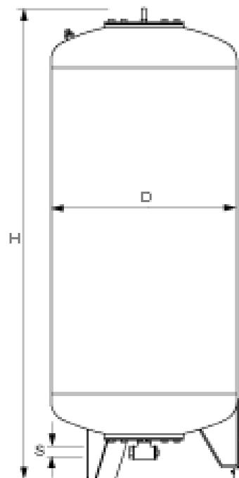
Первичный бак. Измерительная пята для измерения уровня. Включая монтажный комплект для соединения бака с водяной стороны.
