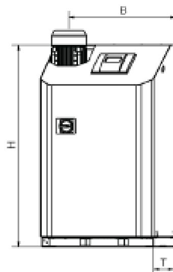
Точное поддержание давления  $\pm 0.2$  бар. 1 насос. 1 перепускной клапан для дегазации и поддержания давления. 1 перепускной клапан для поддержания давления при пиковой нагрузке.
