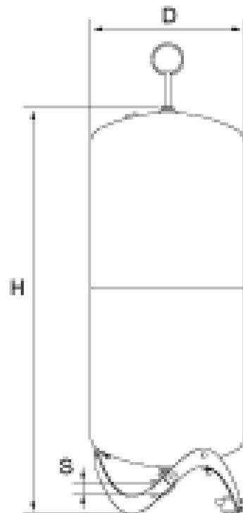
Первичный бак. Измерительная пята для измерения уровня. Включая монтажный комплект для соединения бака с водяной стороны.
