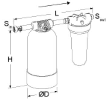
Гидравлический модуль для умягчения воды, для использования с Vento/Transfero Connect TecBox. Фильтр с размером ячейки сетки 25 мкм для защиты системы. Колба для умягчения, заполненная высококачественной смолой.
