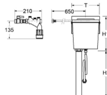
Гидравлический блок для работы подпитки с Vento/Transfero Connect. Состоит из блока Pleno P BA4 R и Pleno P AB5, Класс защиты 5 согласно EN 1717.
