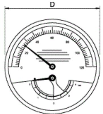
Диапазон отображения давления 0-4 бар, диапазон отображения температуры 0-120 °С, с зеленым указателем для маркировки рабочего давления.
