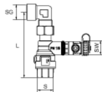
Внутренняя резьба (с плоским уплотнением) с обеих сторон, 90° колено для непосредственного соединения с расширительными баками Statico SU.
